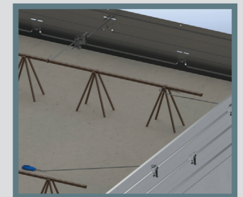
Plaatsen van de breedplaatvloeren cq. kanaalplaatvloeren. vervolgens de randkist afschoren met spanners.
